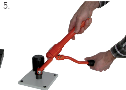
Vorbohren - Bei Schraube \varnothing 9,5 mm, mit \varnothing 10,5 mm - Bei Schraube \varnothing 11,1 mm, mit \varnothing 12 mm - Bei Schraube \varnothing 19 mm, mit \varnothing 20 mm, bei Schraube \varnothing 19 mm kann auch mit \varnothing 20,4 mm vorgestanzt werden - Bei Formlochern: größter Betätigungsschraubendurchmesser + 1,5 bis 2 mm
