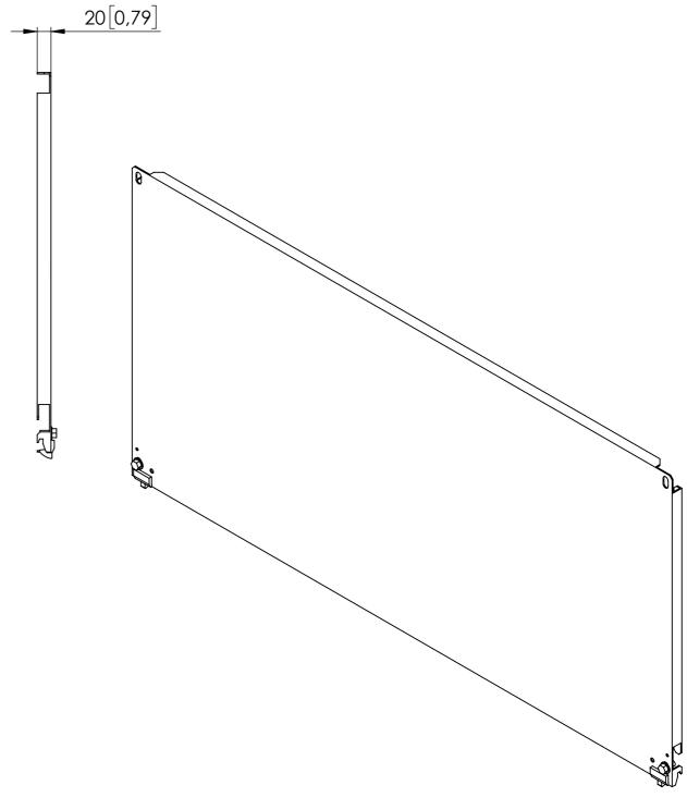
Blechstärke: 2[0,08] / 14 ga Schutzleiteranschluss: 2 x Ø 6.8
