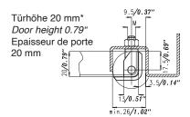
\* Abbildung zeigt die Kunststoff- oder VA-Ausführung. Bei der Zinkdruckguß-Variante wird die gleiche Scharnierhalterung wie bei Türhöhe 15 mm verwendet. Das bedeutet, dass nach der Montage noch ein Teil des Türschnittes zu sehen ist.
