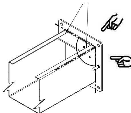
**3.2) Anschweißen eines Endstücks (Zubehör) zum Verschließen eines offenen Kanalendes / Welding of an end piece (accessories) for closing an open duct end / Soudure d'une pièce terminale pour fermer l'extrémité ouverte d'un caniveau à câbles**
