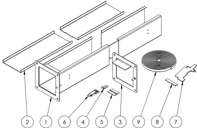
**2) Zuschnittlänge ermitteln, Kanal und Deckel kürzen / Determine length, cut cable duct and cover to length / Déterminez la longueur, mettez le caniveau et le couvercle à longueur**
