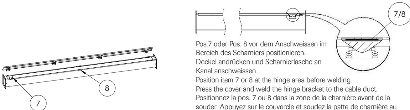
Pos.7 oder Pos. 8 vor dem Anschweißen im Bereich des Scharniers positionieren.
