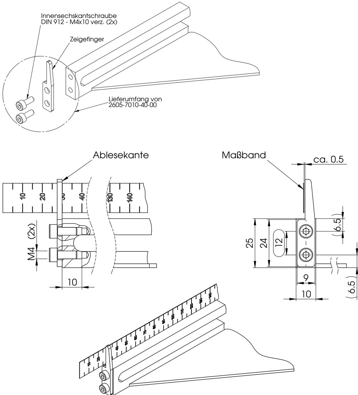
Um den Zeigefinger an dem Tiefenanschlag zu befestigen, müssen zwei Gewinde M4 geschnitten werden.
