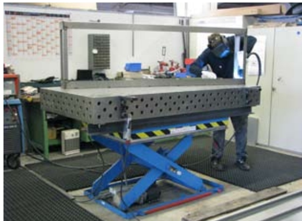
Einsatz ergonomischer Handhabungsgeräte
