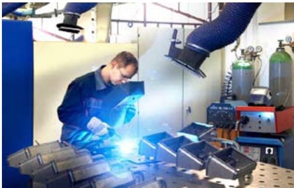
Schweißarbeitsplatz mit Direktabsaugung
