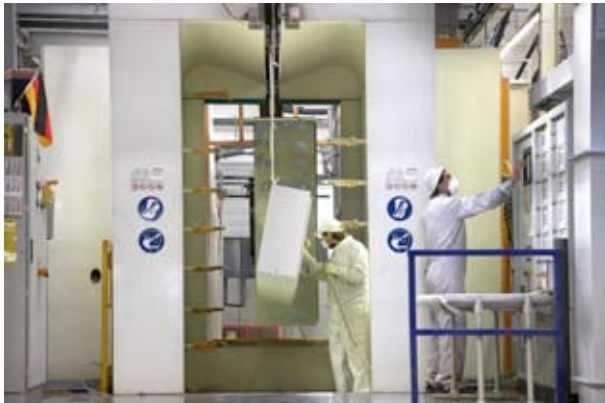
Abwasserfreie Lackierung durch Pulverbeschichtung
