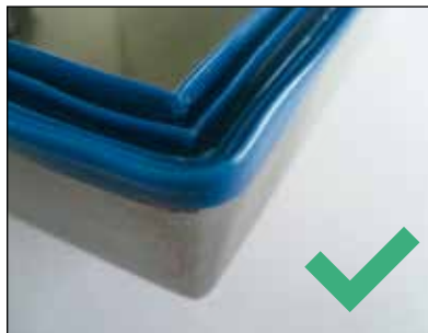
Richtig Dichtung liegt über der Blechkante
