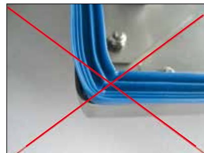
Achtung Die Dichtung beim Einbau nicht aus den Ecken ziehen.
