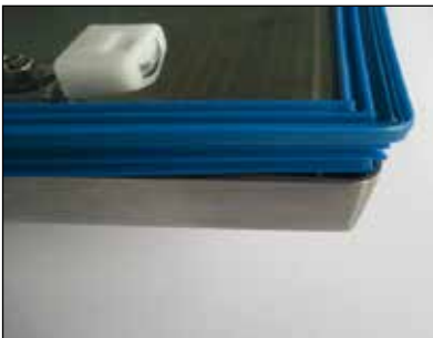
Dichtungsrahmen auf der Nut der Tür aufsetzen
