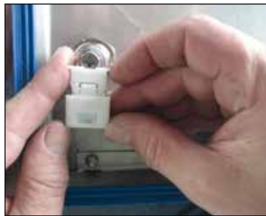
Verriegelungskeil einschieben und einrasten
