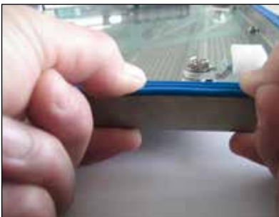
Die komplette Dichtung in die Nut bis zur Türkante eindrücken
