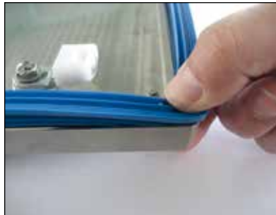
An den vier Ecken der Tür die Dichtung in die Nut eindrücken
