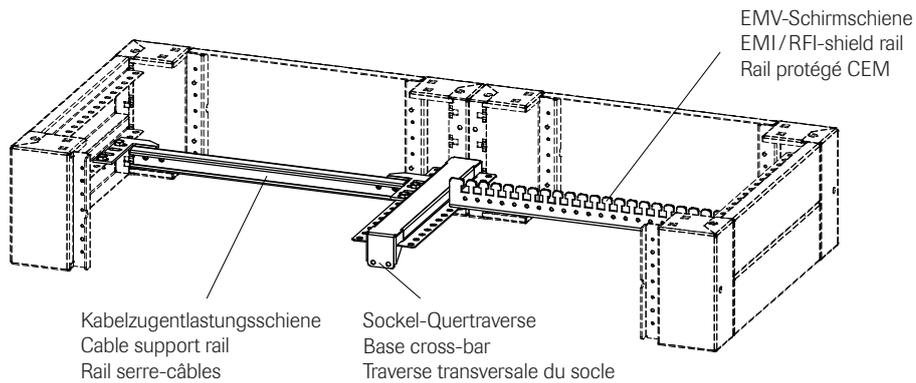
Empfohlener Einbau bei Anreihung und Sockelbreite 1600 und 2000 mm
